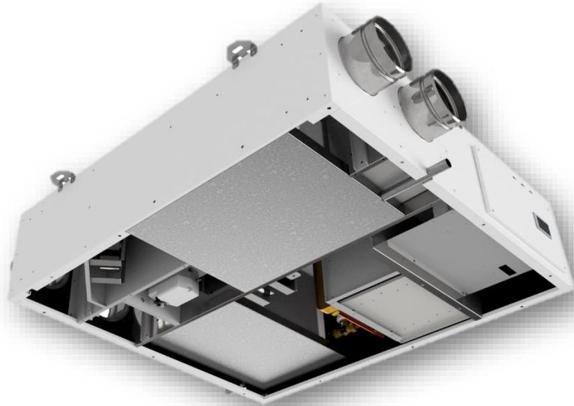
Unità di ventilazione a doppio flusso per il rinnovo dell'aria con recuperatore di calore e circuito frigorifero ad espansione diretta, il quale, collegato all'impianto di riscaldamento/raffrescamento dell'edificio, permette la deumidificazione (estiva) ed integrazione (estiva ed invernale) ottimizzando il comfort in ambienti dotati di sistemi radiantì per il riscaldamento e raffrescamento.
